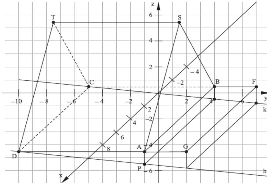
Die beiden Grundseiten des Trapezes sind die Höhen der Punkte A und G (bzw. B und F) über der Hangebene E.
